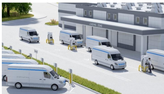
Figura 4 Rappresentazione di un nodo logistico, con punti di ricarica ad uso pubblico dedicati a veicoli merci (in basso) e raffigurazione di un destination charger, con punti di ricarica privati durante il carico/scarico merci. Source:ABB
